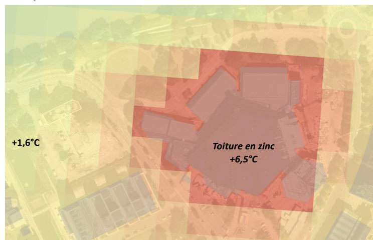
Écart de températures de surface sur le Palais des Sports de Beaulieu à Nantes
